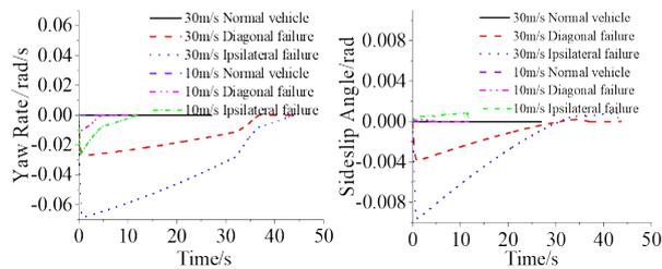
(c) Yaw rate diagram. (d) Sideslip angle diagram.
